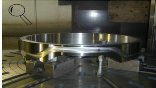
Trommelkurven bis  $\varnothing$  3000 mm
