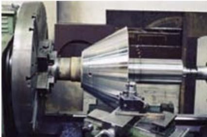
Reparatur eines Brecherkegels von einem Kreiselbrecher.
