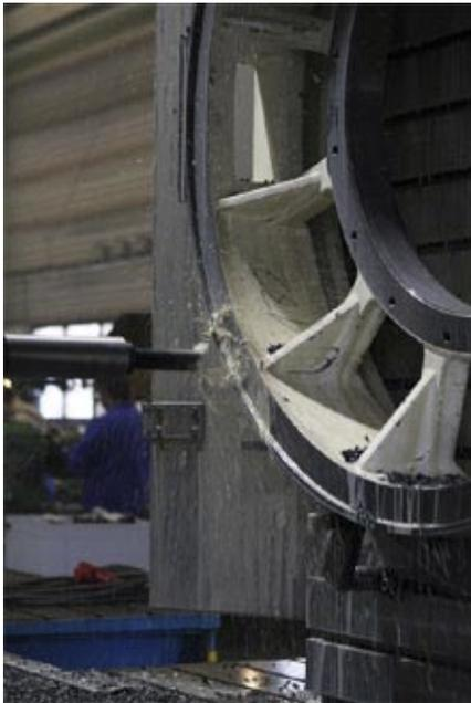
Flansch für Windkraftgetriebe mit einer Leistung von 3 Megawatt komplett mechanisch bearbeitet.
