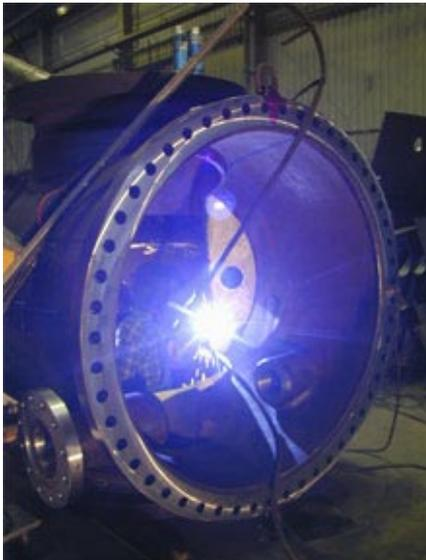
Komplettanfertigung eines **Gehäuses für Rückschlagklappe DN 40"** inklusive Stahlbau, mechanische Bearbeitung, Lackierung und Transport. Abmaße: Ø 1850 mm x 2200 mm hoch. Gewicht: 5 to.
