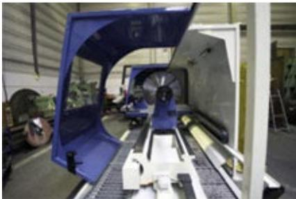
Die neue CNC-Drehmaschine Krewema HFDM 55 ist in Betrieb genommen worden. Wir sind jetzt in der Lage CNC-Dreharbeiten bis zu einem  $\varnothing$  2000 mm an der Planscheibe, bis zu einem  $\varnothing$  1420 mm x 4300 mm Länge über dem Maschinenbett und bis zu einem  $\varnothing$  920 mm über dem Support anzunehmen.
